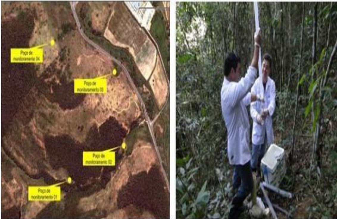
Monitoramento dos poços de água a montante e jusante do aterro.
